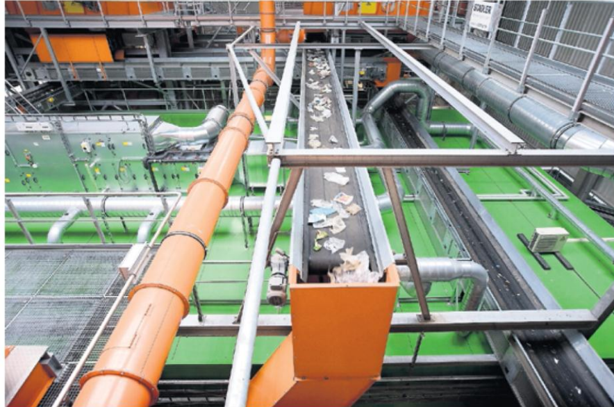
Sorteerinstallatie voor kunststof verpakkingsafval bij afvalverwerkingsbedrijf Sita.
